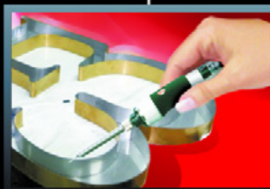
Пайка корпусов букв и лазерная сварка
