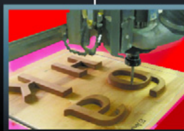
Изготовление пресс-форм для формовки лицевых частей букв
